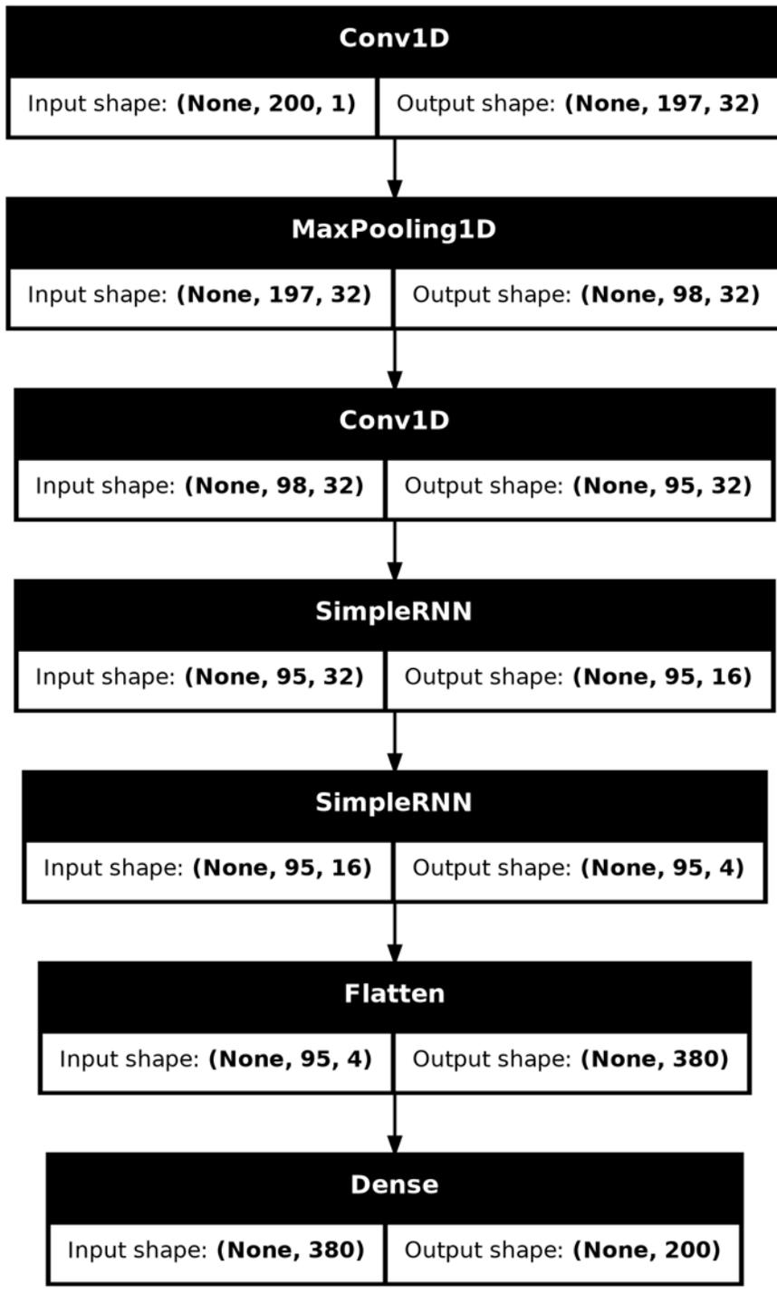
1. Notre entrée est une time serie de 200 échantillons ( **$a(200,1)$** ), fait passer ça dans 32 filtres de convolutions de taille 4.
