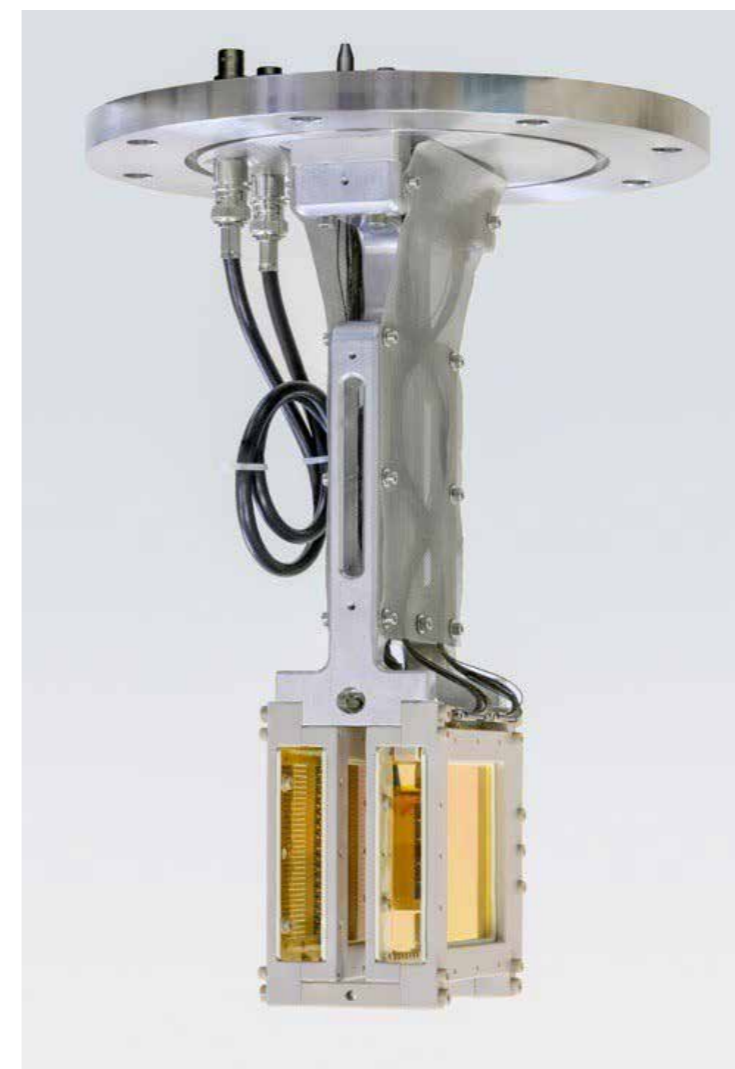
Figure 62 Prototype du profileur de faisceau PEPITES monté sur son support avec sa zone sensible (en or). La photographie montre la réalisation de la zone sensible, montée sur son support. Celle-ci comporte 2x32 voies. Le WET de cet ensemble est de 10µm. On remarque, en haut à droite du bloc, les nappes de câbles partant de la zone sensible et rejoignant la bride refermant le système en courant sous un fin grillage. Cette connexion de très haute qualité permet de transporter des courants aussi bas que le fA. On voit également les deux câbles épais pour amener les tensions.
