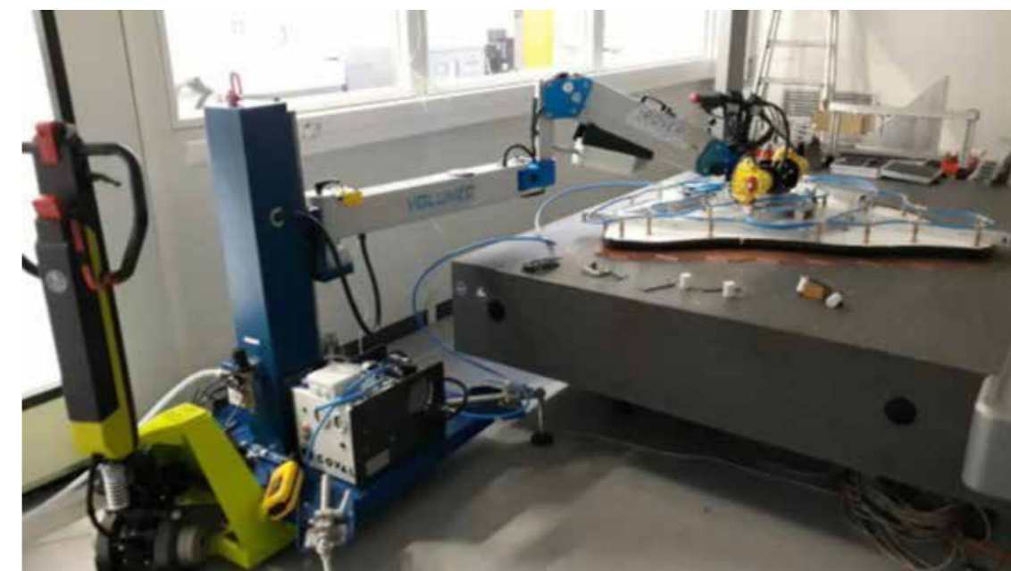
Figure 9 Bras robotique et palonnier à ventouses levant une plaque Cu posée sur le marbre de la machine de mesure tridimensionnelle
