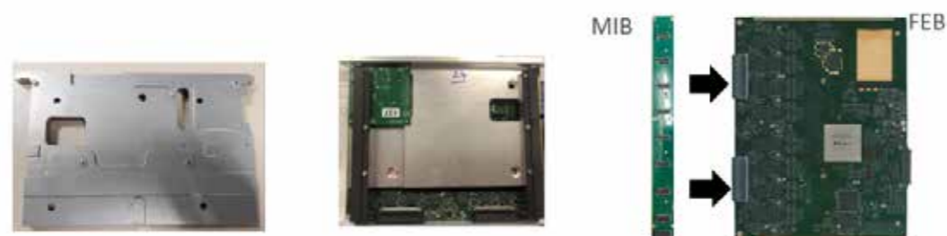
Figure 29 Plaque de refroidissement réalisée au LLR, et son adaptation sur la carte FEB (gauche). La carte MIB, qui regroupe huit câbles de signaux pour les connecter à la carte FEB, grâce aux deux gros connecteurs situés sur l'autre face (droite).
