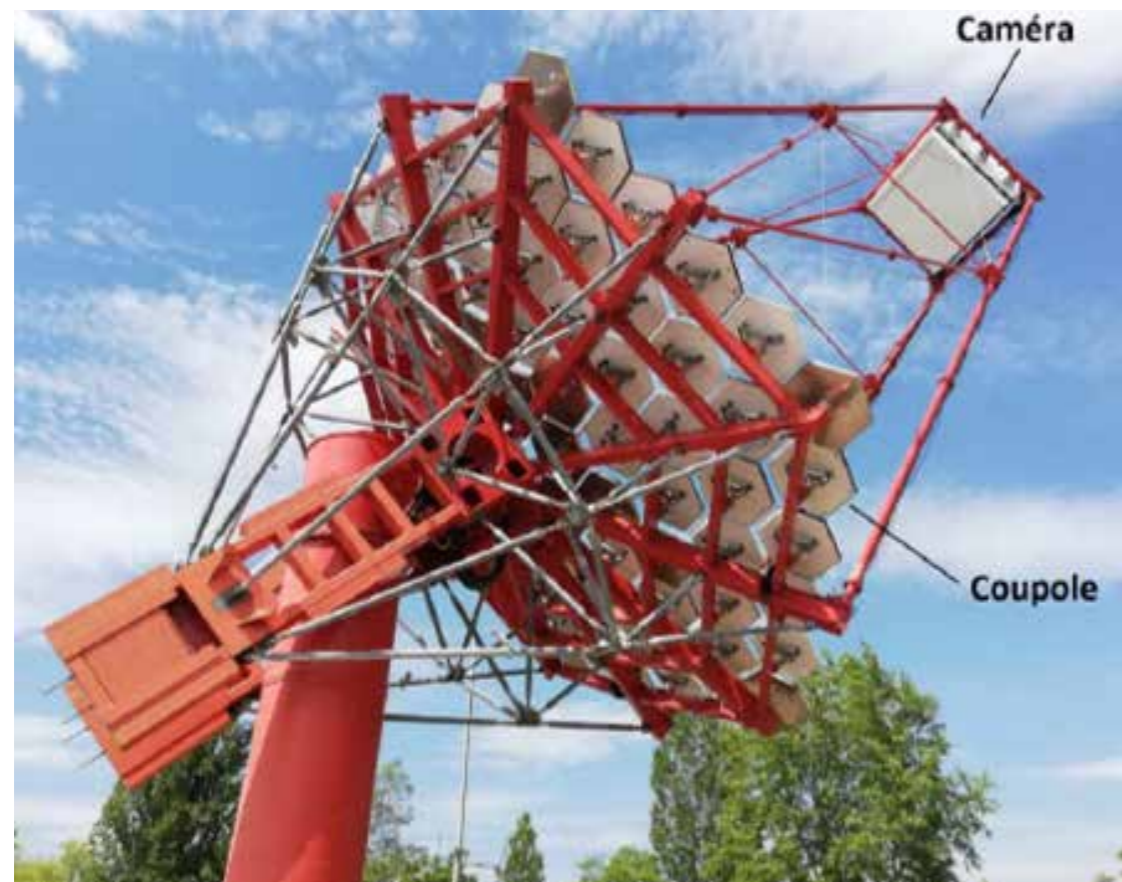
Figure 56 Télescope de taille moyenne (MST) pour le projet Čerenkov Telescope Array (CTA) composé de miroirs de forme hexagonale créant un réflecteur uniforme d'environ 12 mètres de diamètre. La surface réfléchissante de 88 m 2 recueille et concentre la lumière Čerenkov dans la caméra, où la lumière peut être numérisée et traitée. Le site nord de CTA fonctionnera avec les caméras NectarCAM à grand champ de vision (environ 8°) et utilisant des photomultiplicateurs.
