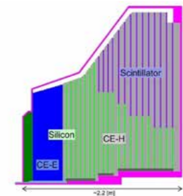
Figure 7 Demi-coupe d'un des deux embouts de calorimétrie haute-granularité HGAL. La projection est montrée ici dans un plan parallèle à l'axe des faisceaux de protons.
