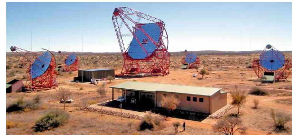
Figure 53 Expérience H.E.S.S., avec son réseau de 5 télescopes Čerenkov, installée sur un plateau à 1800m au-dessus de la mer dans la région du Khomas en Namibie.
