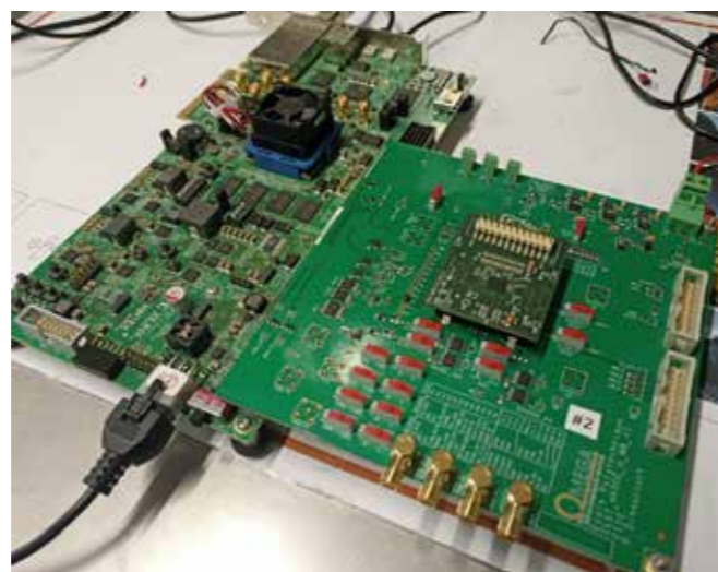
Figure 40 Carte de test (appelée version 0) de l'ASIC HKROC.
