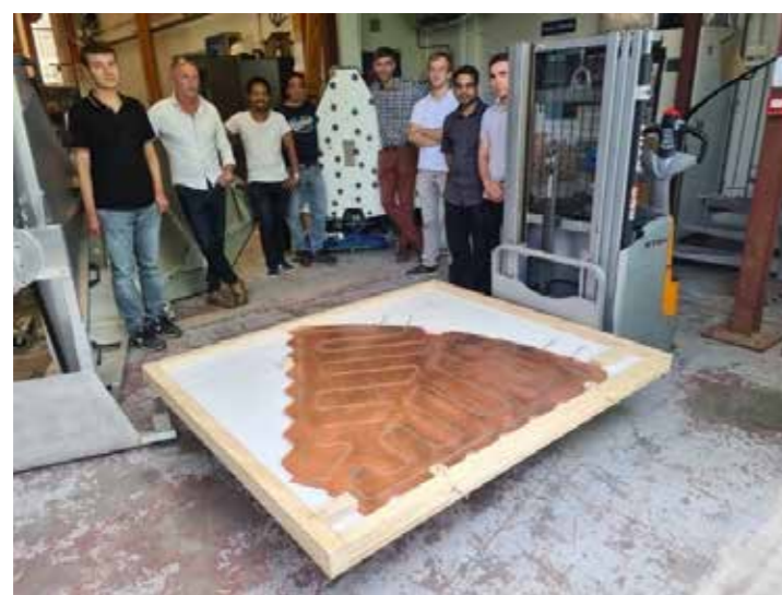
Figure 8 Prototype de plaque de refroidissement en cuivre de HGCAL réalisée au sein du LLR, avant sa livraison au CERN
