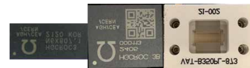
Figure 11 À gauche : Puce HGCROC HD de taille 17.0 x 8.0mm. Au centre : Puce HGCROC LD de taille 20.0 x 16.8mm. À droite : « Socket » servant à connecter les puces HD au banc de test.
