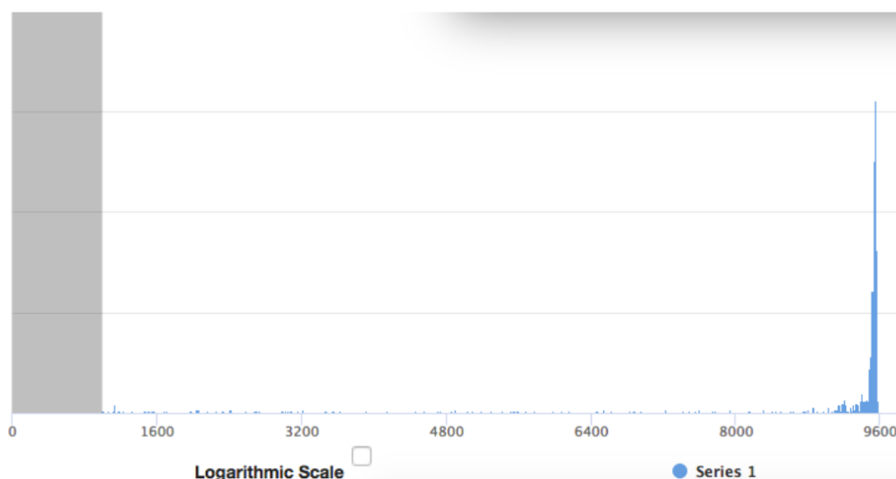
Spectre d'une source de Po210 de 40Bq a 1cm de la diode Pin Hamamatsu (φ 3.6 mm)
