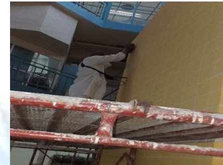
Contrôle par Ultrasons du béton du réacteur TRICO II
