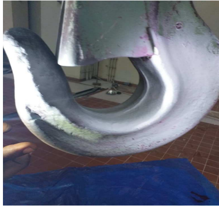
Contrôle par ressuage du crochet du palan du réacteur TRICO II
