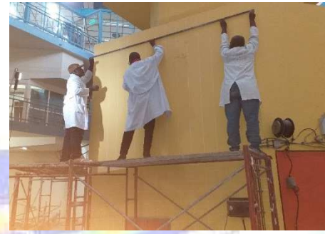
Contrôle par Ultrasons du béton du réacteur TRICO II
