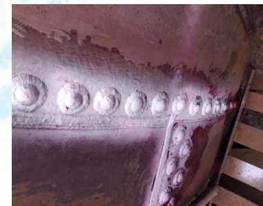
Contrôle par ressuage des conduites forcées du barrage de SANGA
