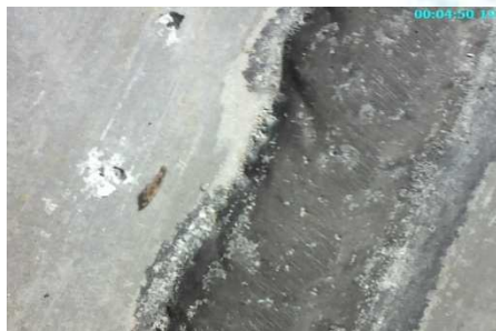
Inspection visuelle au moyen d'un endoscope des cordons de soudure de la cuve du réacteur TRICO II
