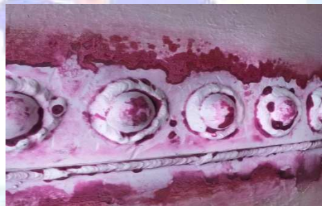
Contrôle par ressuage des conduites forcées du barrage de SANGA
