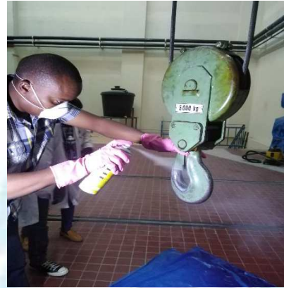
Contrôle par ressuage du crochet du palan du réacteur TRICO II
