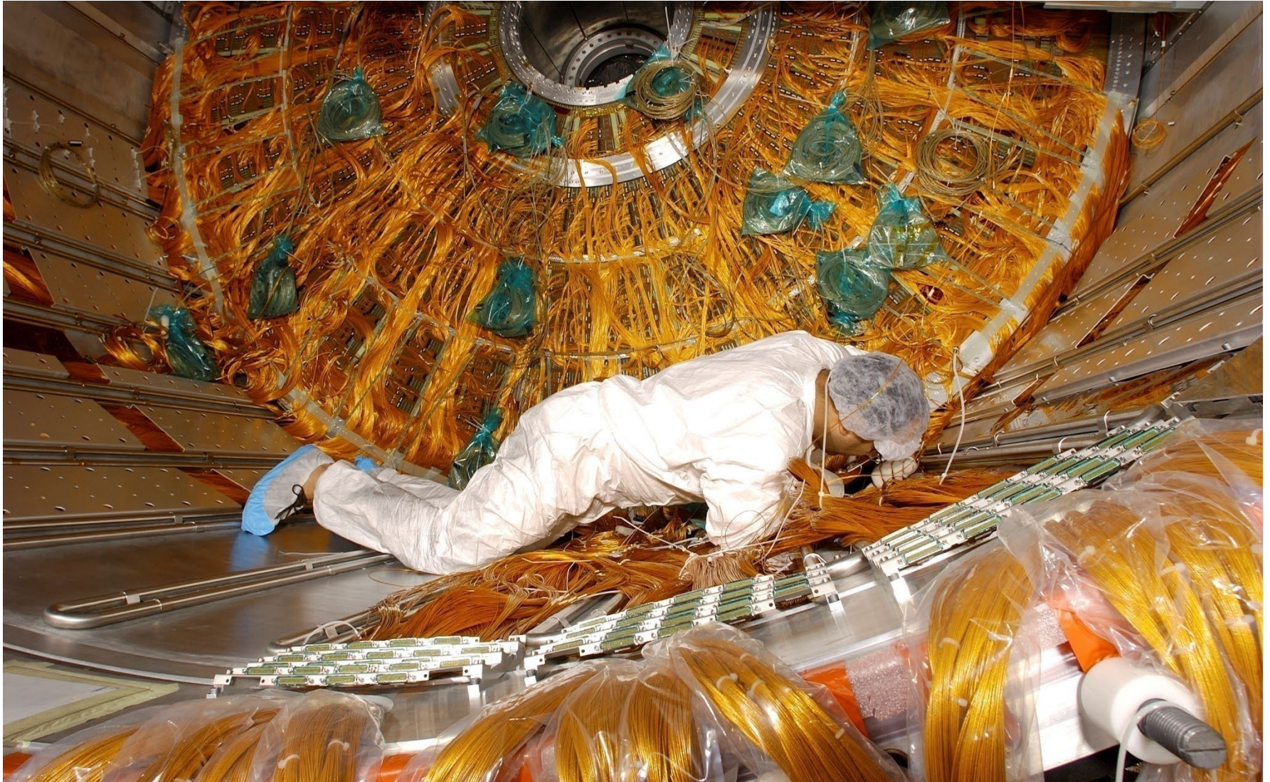
Installation d'un élément du détecteur d'ATLAS © Cern
