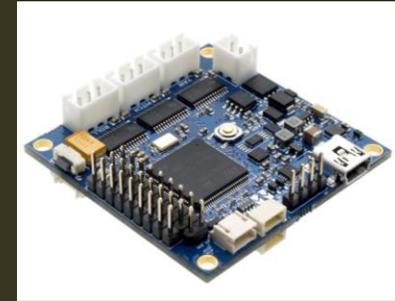
**Carte Permettant la gestion du GIMBAL possibilité d'ajouter des codeur sur les axes moteurs**
