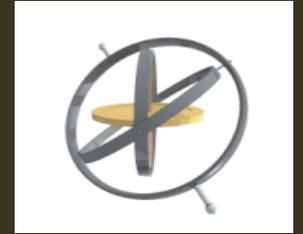
Un **gimbal** est un stabilisateur mécanique qui réduit les tremblements en stabilisant un appareil sur trois axes (Roll, Pitch, Yaw) pour une orientation optimale.
