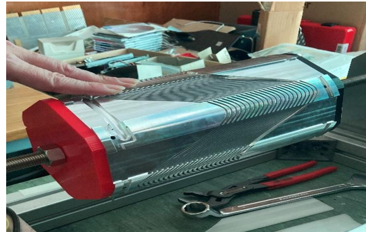
Bobinage du sextupôle
