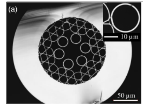
FIGURE 2.2 – (a) Image par microscopie électronique à balayage d'une HC-PCF (b) maille élémentaire de la gaine microstructurée à maille hexagonale [66], (c) définition de \Lambda et d du cristal d'une HC-PCF [74].
