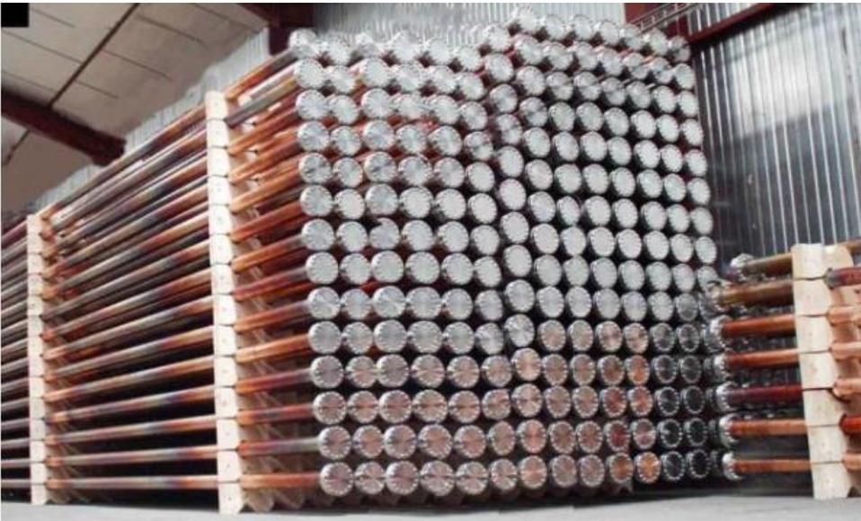
Chambre déposées NEG pour le LHC
