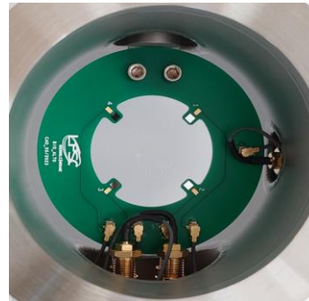
Compteur 4 diamants & électronique dédiée développée LPSC
