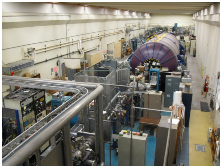
Tandem Van de Graaf Accelerator 1 to 5 MeV protons
