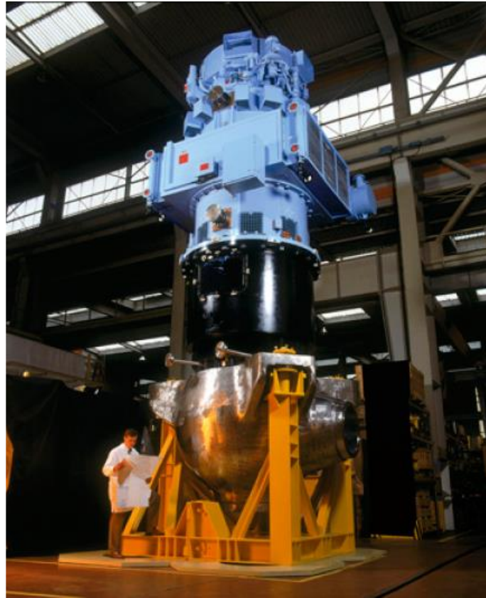
Pompe primaire pour un réacteur 1 450 MWe. Usine AREVA de Jeumont (France). Copyright JSPM / Studio Pons.
