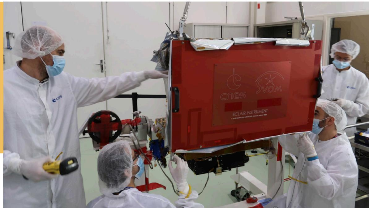
ECLAIRs est doté d'un système thermique pour maintenir les détecteurs à -20°C. Son blindage en plomb est recouvert de cuivre pour des besoins de calibration
