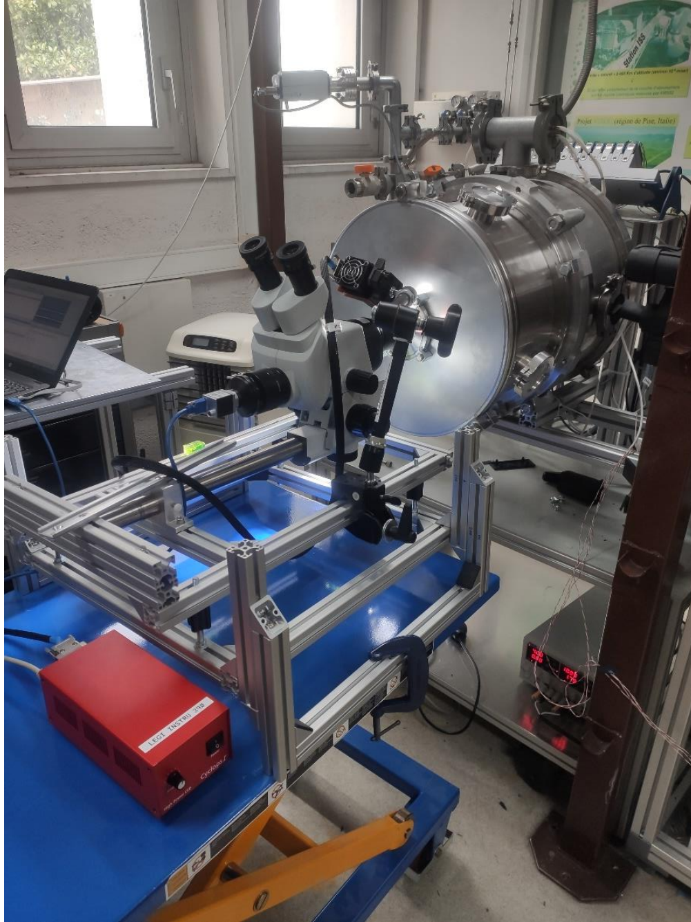
Le binoculaire, la caméra et le dispositif d'éclairage (matériel du LEGI) devant l'enceinte fermé (sous vide).
