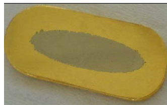
Ni-64 electroplating on Au ⇒ Cu-64
