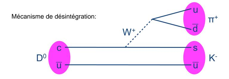
On peut identifier le D<sup>0</sup> par sa désintégration en mode K $\bar{}$  $\pi^+$ . Le K et le  $\pi$  ne sont pas stables mais ont une durée de vie suffisamment longue pour être détectés et identifiés dans LHCb.
