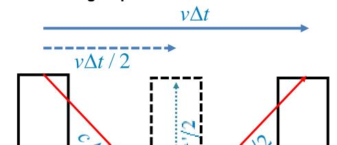
$(c\Delta t/2)^{2} = (c\Delta t'/2)^{2} + (v\Delta t/2)^{2}$   $\Delta t^{2} (1 - v^{2}/c^{2}) = \Delta t'^{2}$   $\Delta t = \gamma \Delta t' \quad avec \quad \gamma = \frac{1}{\sqrt{1 - v^{2}/c^{2}}}$
