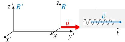
Mécanique relativiste :  $v' = \frac{u+v}{1+\frac{uv}{c^2}}$   $= Si \frac{u}{c} \ll 1 \text{ et } \frac{v}{c} \ll 1 : v' \simeq u+c$   $= Si v = c : c' = \frac{u+c}{1+\frac{u}{c}} = c$
