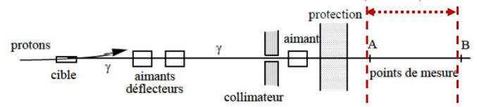
On mesure la vitesse de ces photons dans le laboratoire en mesurant le temps qu'ils mettent pour parcourir la distance entre deux détecteurs A et B séparés de 31,450 m. Cette durée est de **104,9 ns.** On a donc:
