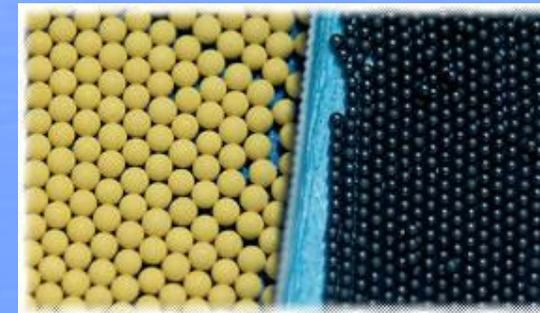
⇒ recherches sur le matériau de la coque des microbilles contenant le combustible,
