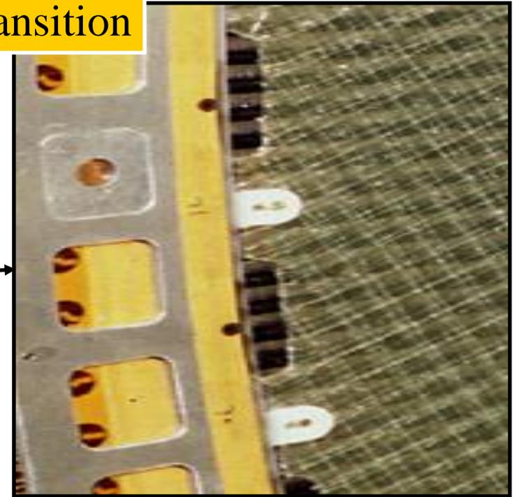
Assemblage de feuilles plastiques (renforcées) et de tube ou « paille » (*straw*) de 5mm de diamètre.
