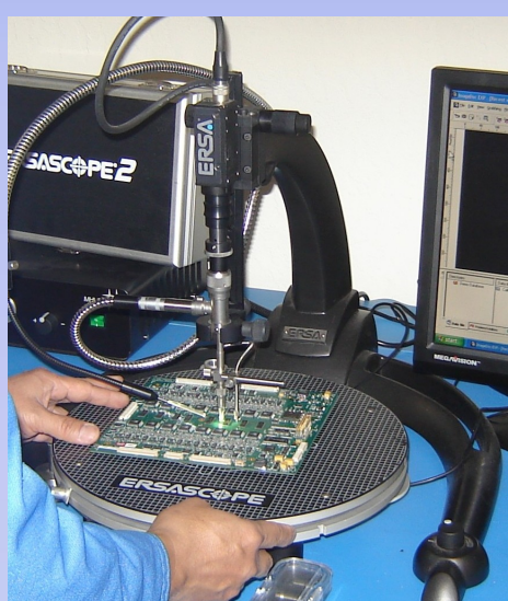
Inspection visuelle CMS/BGA ERSASCOPE
