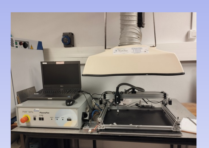
Nettoyage de surface par ionisation plasma
