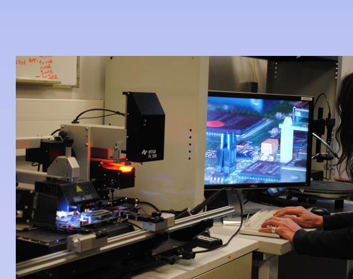
Placement précis des composants ERSA PL 550 A
