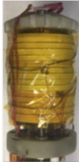
45,5T 14,5T HTS+ 31T LTS ID 14mm
