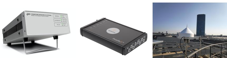
Figure 4 – À gauche : l'horloge rubidium. À droite : le récepteur Septentrio PolRx5TR et son antenne sur le toit de la tour 13.
