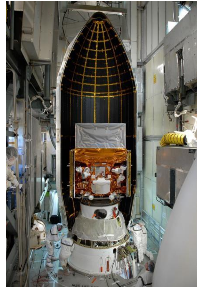
Installation de GLAST/FERMI dans la fusée DELTA II
