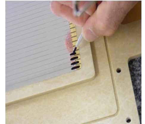
Connection des pistes à la pate à l'argent (ou autre)
