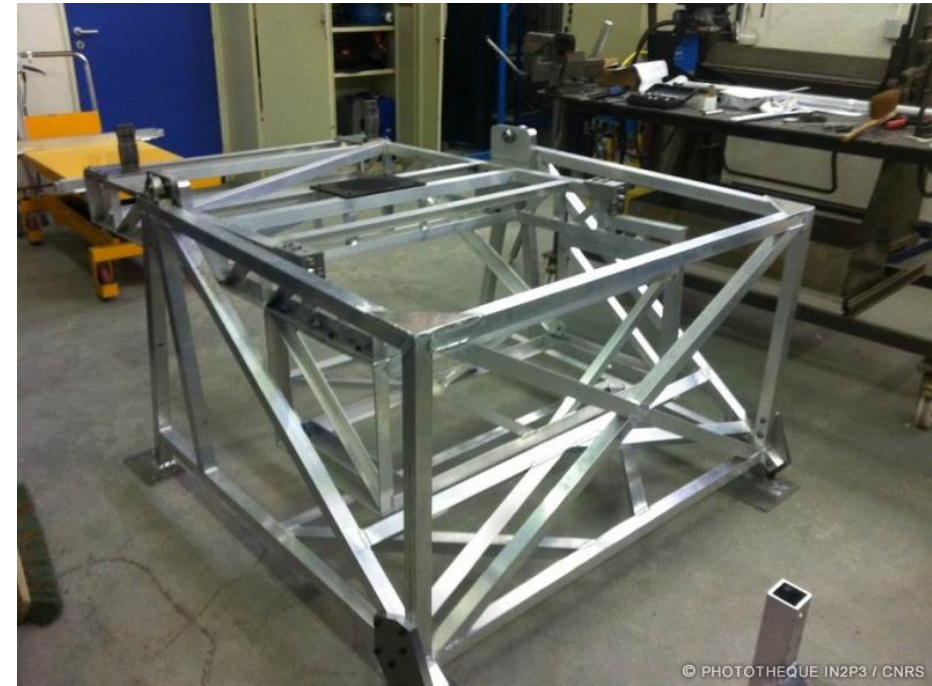
Châssis en aluminium soudé pour le chargeur de filtre de LSST
