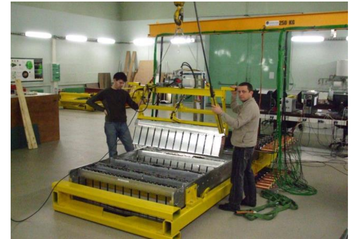
Assemblage des Stripmodules en Supermodule
