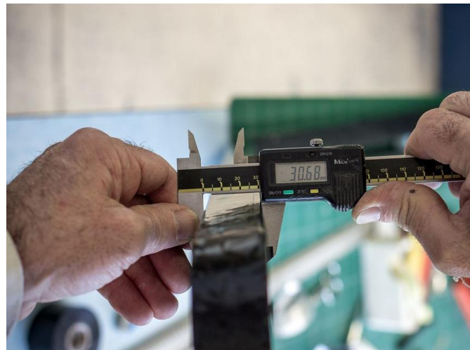
Vérification de l'épaisseur d'une latte
