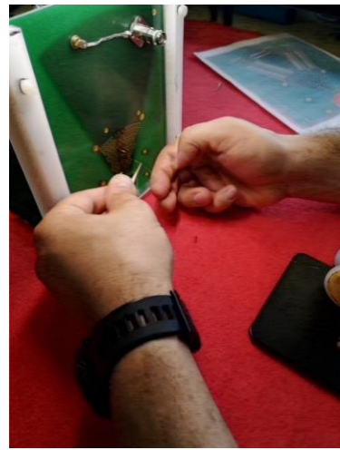
Tenue mécanique des fils par un procédé de sertissage
