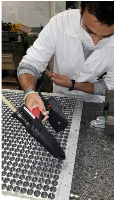
Collage des sondes de température
