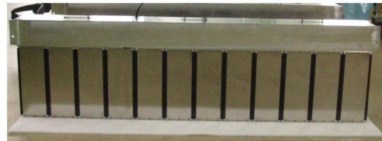
Assemblage des modules en Stripmodule
