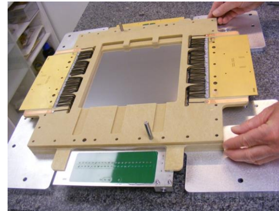
Assemblage des plans avec des pions de centrage
