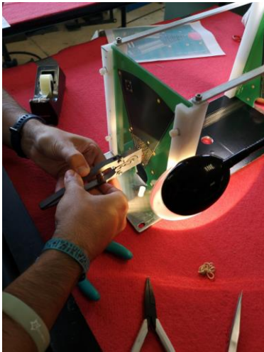
Tenue mécanique des fils par un procédé de sertissage
