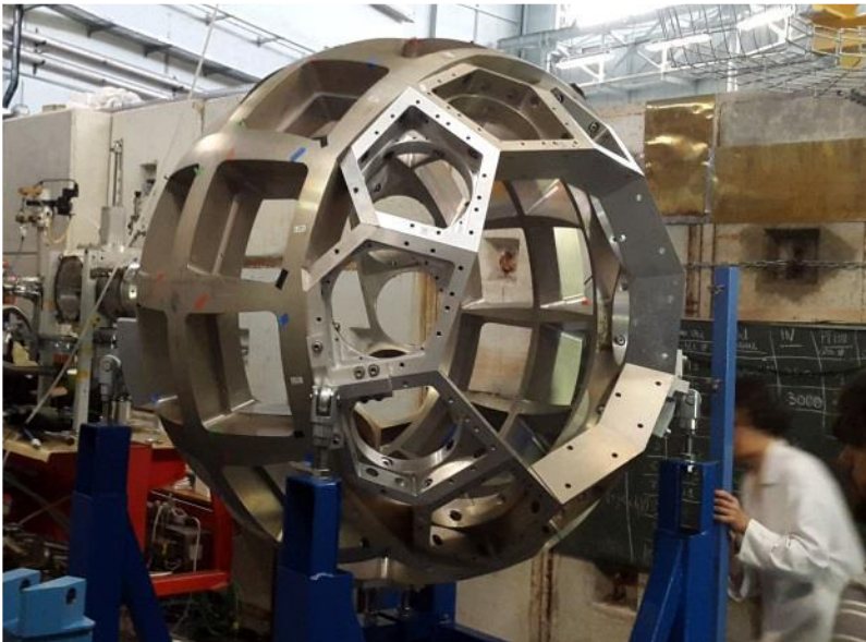
Installation de la structure mécanique sur rails de guidage
