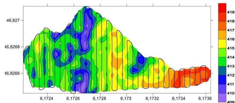
Cartographie des mesures de CO<sub>2</sub> par drone. ©L. Joly, TERRA FORMA
