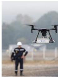
**Cartographie haute résolution des flux de CO<sub>2</sub>, CH<sub>4</sub>, H<sub>2</sub>O embarqué sous drone.**
