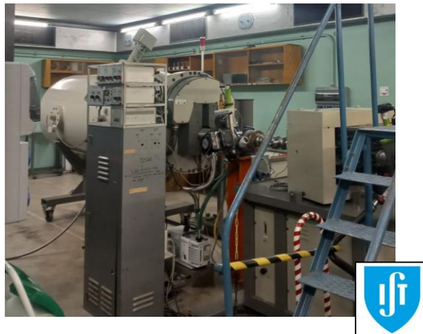
2.5 MV Van de Graaff accelerator at LATR.
