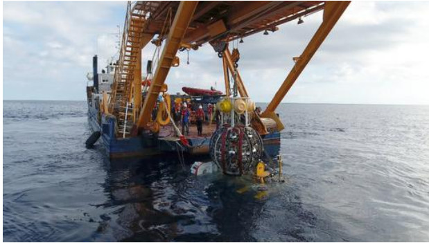
Mise à l'eau détecteur KM3NeT
