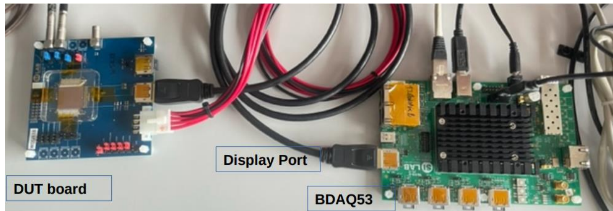
Banc de test de TJ-Monopix2
