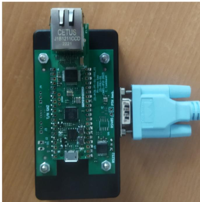
Figure: Boitier d'adaptation vers une interface RS232 (LV ou balance). Un capteur P/T/H ambient BME280 est rajouté pour monitorer les variations de pression.
