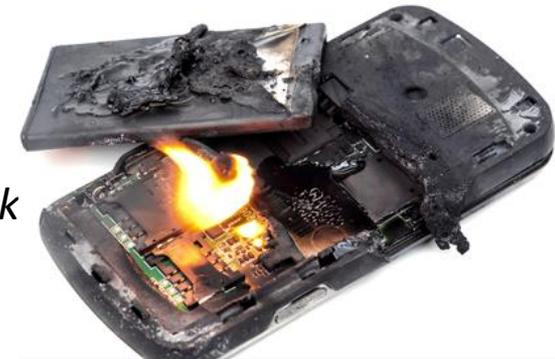
**Solution: développement de séparateurs à base d'électrolytes solides (« batterie tout solide ») ou séparateurs renforcés (couche d'alumine)**
