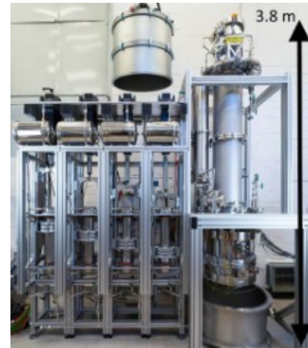
XENONnT online distillation < 1 \mu Bq/kg (arXiv:2205.11492)
