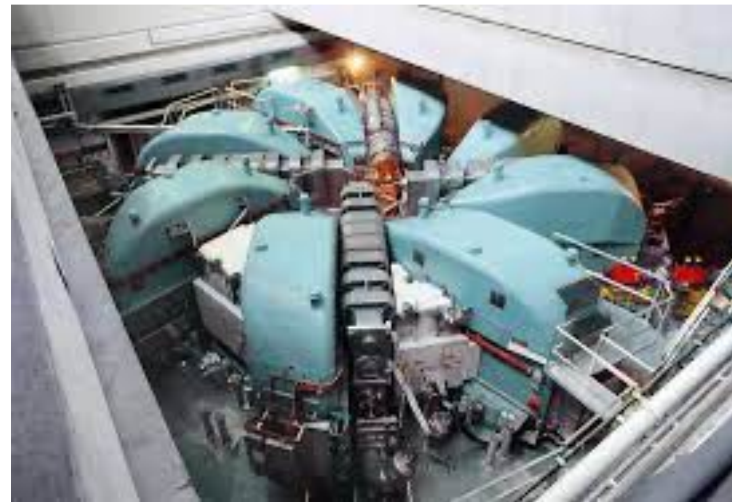
1.4 MW 590 MeV proton accelerator
