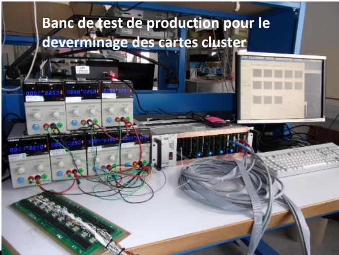
1 er émulateur carte Pacific pour le test des cartes clusters
