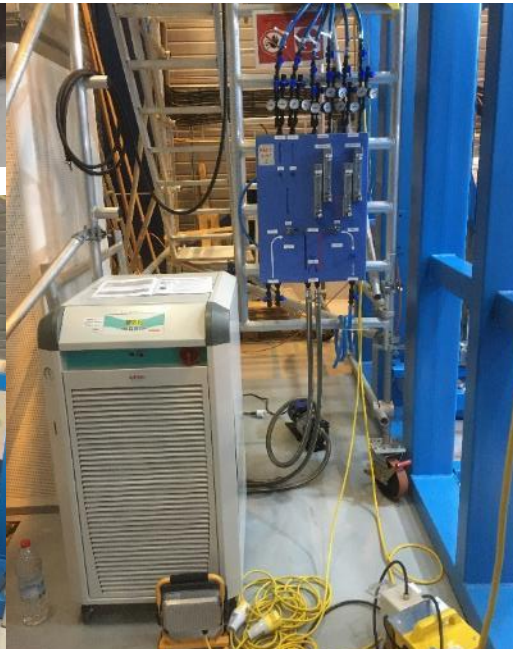
Cframe : système de génération et régulation du refroidissement par eau
