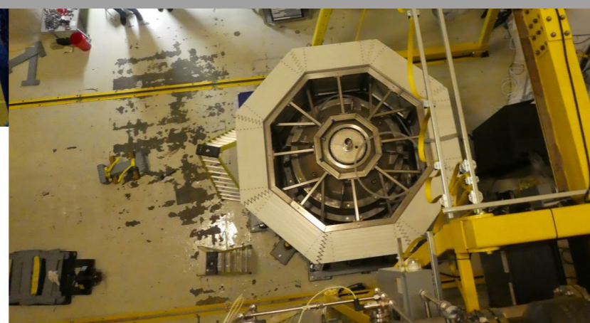
PE shielding installation
