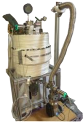
Proto 1: TPC Sphérique (creusée dans un cylindre) non certifiée
