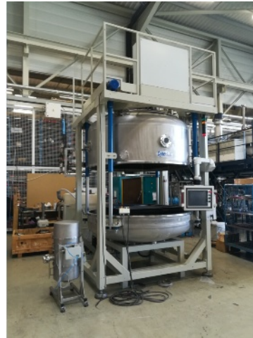
four pour fondre 500 kg d'alumine
