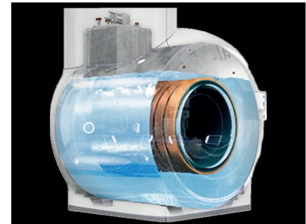
Refroidissement 4K (LHe) aimants supraconducteurs
