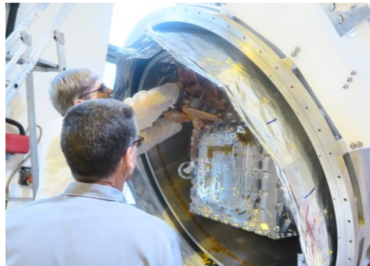
Mise en place frigos Sub-K
