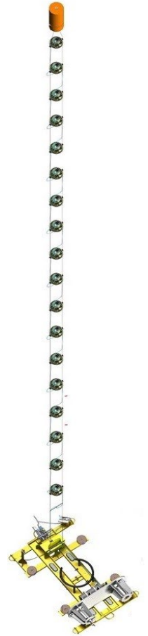
A KM3NeT 'detection unit' (DU)
