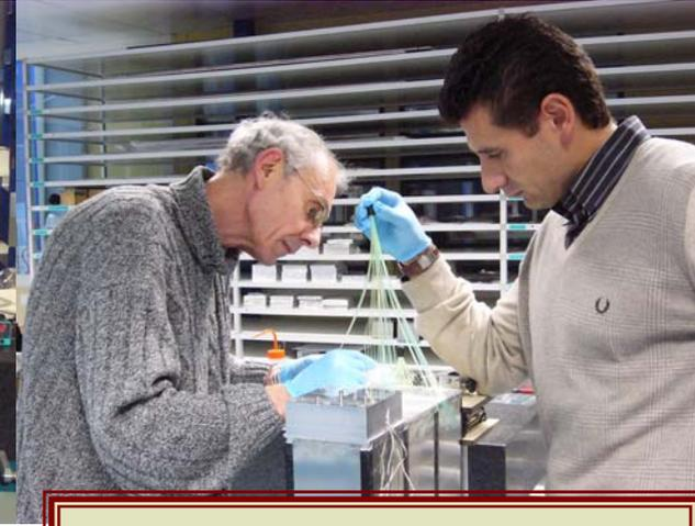
Insertion des fibres optiques
