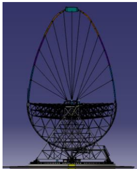
Cadre de liaison de l'arche du télescope
