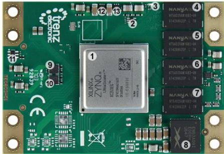
Xilinx Zynq UltraScale+, 2 GByte DDR4 (4 Gbyte DDR4 avec TE808)
