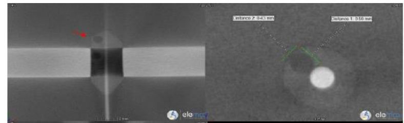
Tomographie perle d'une perle de verre Observation de vide à l'intérieur
