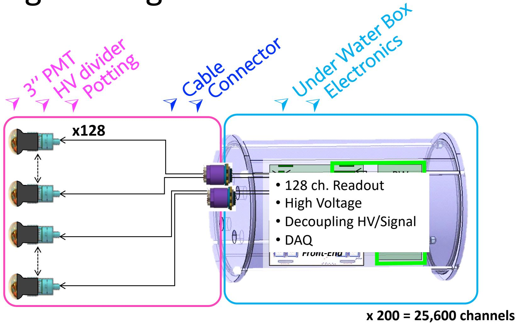
**PMT instrumentation** et **UWB + Electronique** sont conçus et produits en décallage temporal, testés séparément puis installés ensemble sur JUNO
