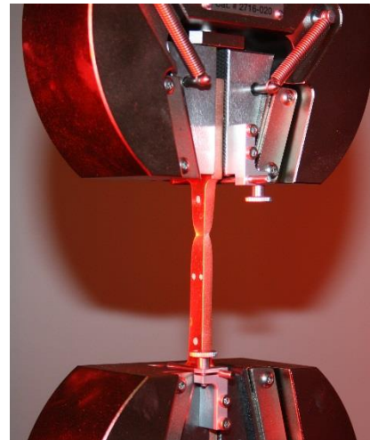
Tests de traction sur éprouvette cuivre
