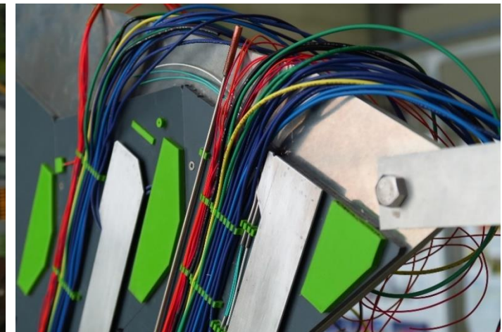
Prototype de câblage au sein même d'une cassette du CE-E
