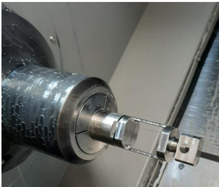
Pièce en cours de réalisation (tour CN)
