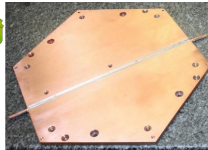
Set up de plaque de cuivre avec son tuyau de refroidissement
