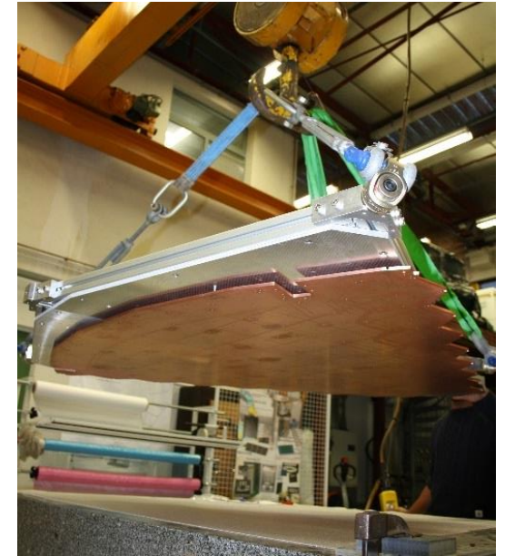
Outillage de manipulation des cassettes du CE-E
