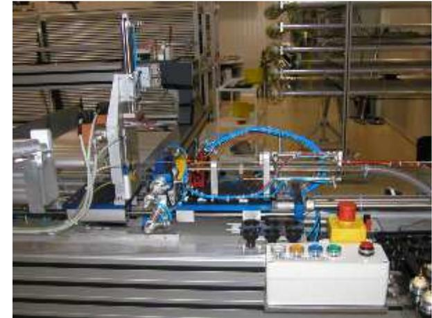
Tissage des tubes (>350000) : fils tungstène ( $50\mu\text{m}$ ) centrés (grâce aux *end-plug*) à mieux que  $20\mu\text{m}$
