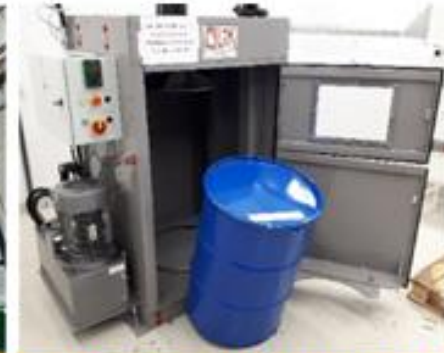
Presse à fût (12 tonnes) Déchets technologiques
