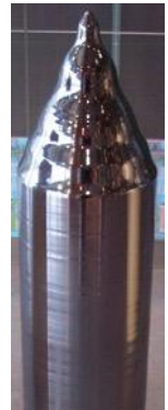
450 mm diameter Si ingot
