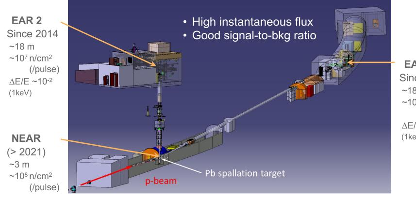
**p-beam**: 0.8 Hz - 20 GeV/c - 7 ns RMS - 7.10<sup>12</sup> p/pulse - 2.10<sup>15</sup> n/pulse (300 n/p)
