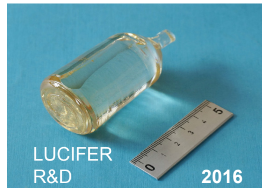
^{116}\text{CdWO}_4 (0.41 kg, ~99% ^{116}\text{Cd} ) JINST 12 (2017) C08011
