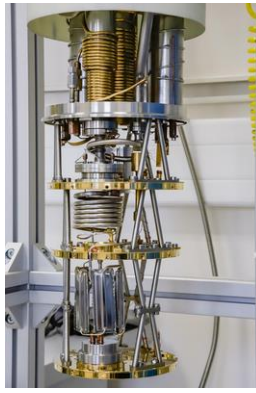
Figure 2 : système de refroidissement à dilution qui va être utilisé pour la phase GrAHal-1.
