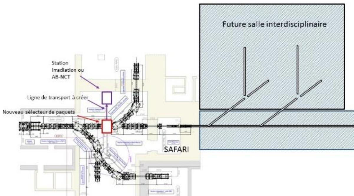
du prototype du convertisseur développé pour SPIRAL2), ainsi qu'une ligne banalisée modulaire. L'ensemble de ces lignes devra être implanté dans une infrastructure permettant une R&D amont de haut niveau.
